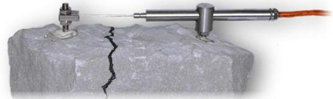
... zur Messung von Fugen-, Riss- oder Felsbewegungen sowie Stangen-Extensometer-Bewegungen
