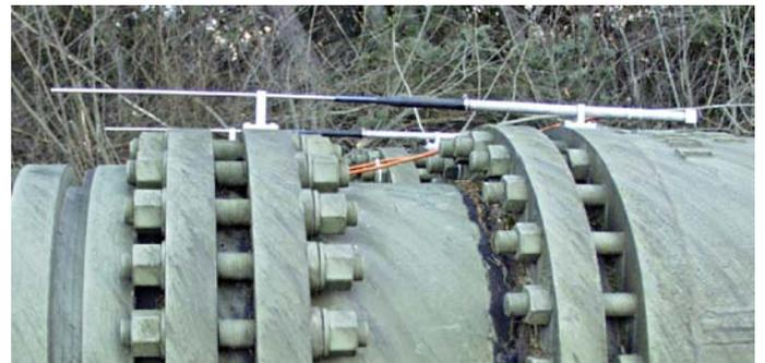
... zur Messung linearer Verschiebungen in Erddämmen, an Hängen, Felsen oder an Druckleitungen etc.
