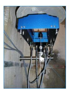
Nach Abschluss der Hauptbauarbeiten wurden Normal- und Schwimmlote installiert, die teilweise mit manuell und teilweise mit automatisch betriebenen Pendelmessgeräten, die nicht von der Huggenberger AG stammen, ausgestattet wurden.
