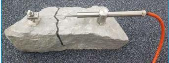
Telejointmeter sensor and Tiltmeter
